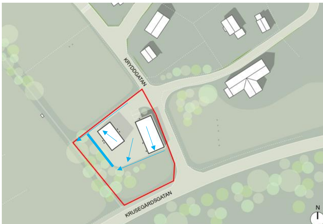
Figur 6-1. Förslag på framtida dagvattenhantering inom utredningsområdet utifrån planerad exploatering. Marknivåer från Lantmäteriet (2025). Avrinningspilar visar förslag på marklutning för att dagvatten ska kunna nå anläggningen ytligt.
